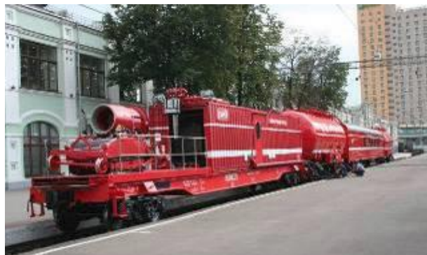
Рисунок 4.7 – Пожарный поезд для обеспечения пожарной безопасности в тоннелях и на объектах железной дороги
